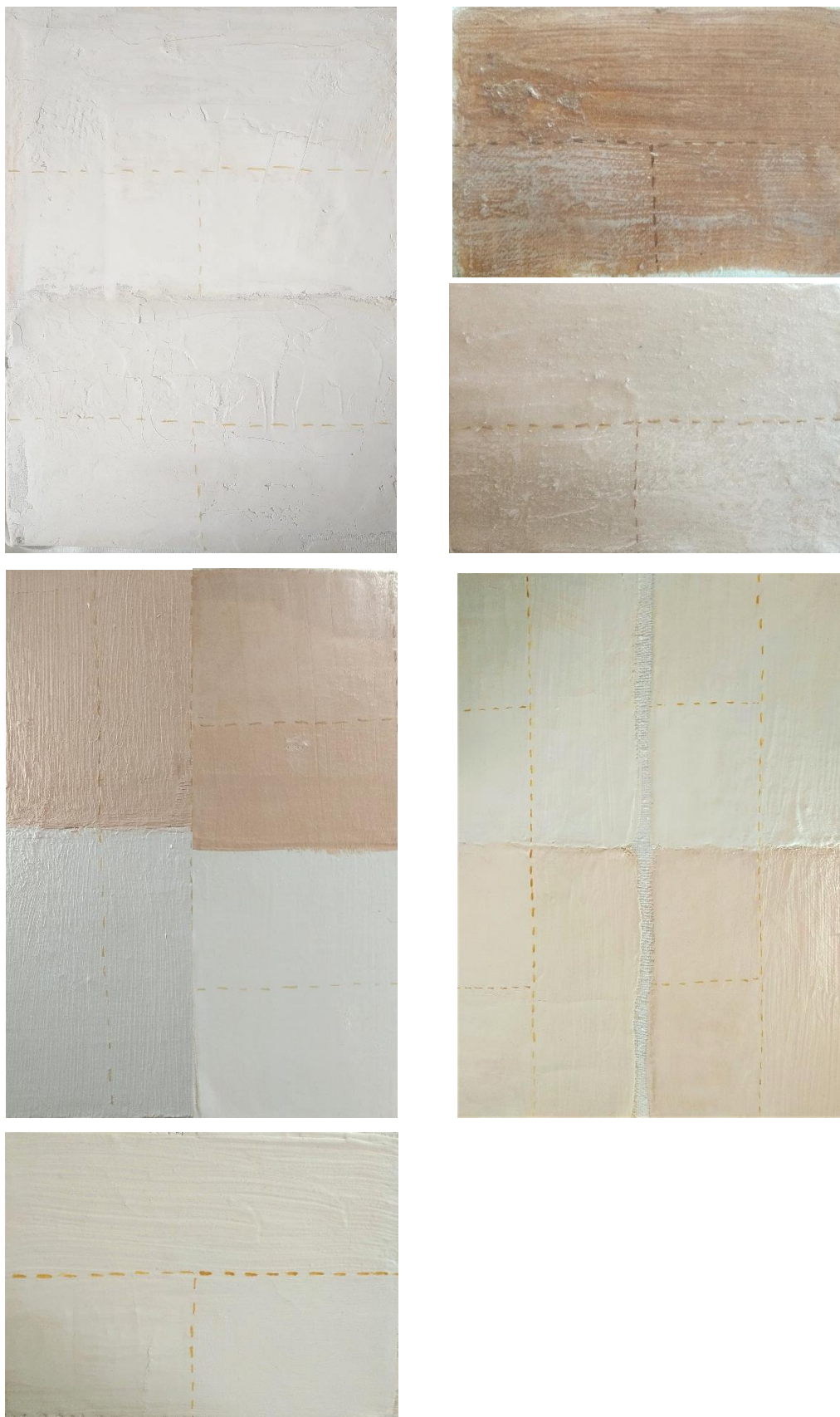
Fig108 a. (A partire dall'alto a sinistra) Prove stuccatura con Modostuc (in alto a sinistraa) e stucco con gesso e colla Lapin (in basso a sinistra); b. Prove stuccatura con Plextol B500 in
