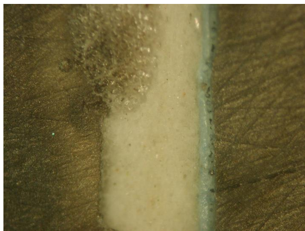
Fig.73 Osservazione al microscopio del campione consolidato solo dal verso con Plexisol e Dowanol PM al 10%.
