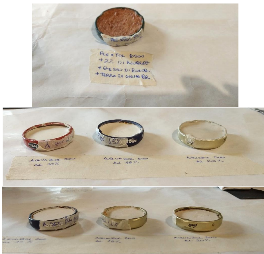
Figg.110-112 Prove di ritiro con lo stucco a base di Plectol e gli stucchi a base di Aquazol 500 e 200. Il Plectol ha un ritiro quasi nullo, mentre gli Aquazol hanno un ritiro inferiore all'1%.
