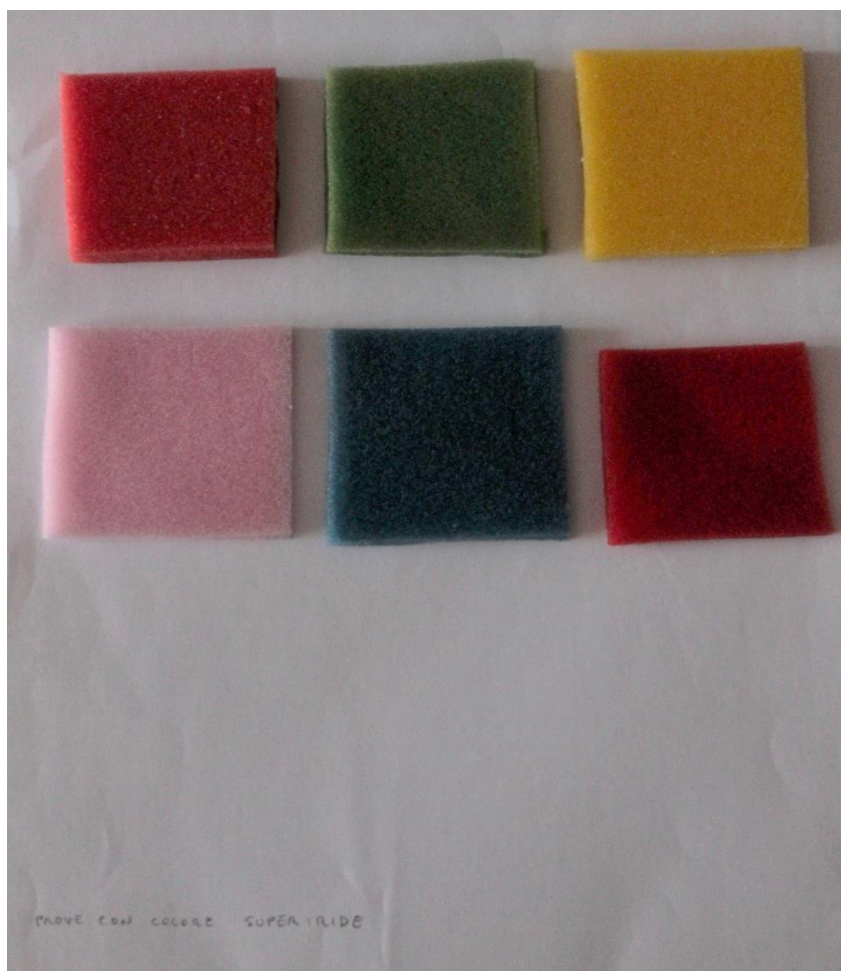
Fig.131 Campioni forniti dall'artista con i colori Super-Iride. Il poliuretano viene immesso in lavatrice insieme al colorante ed al sale che ne permette il fissaggio.
