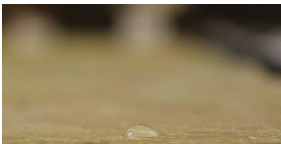
Fig.79 Test dell'angolo di contatto.
