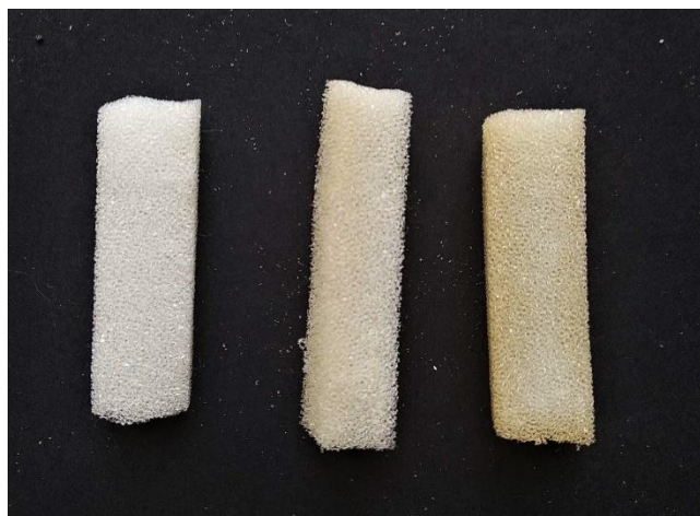
Fig.128 Vista in sezione dei campioni di PUR: si può osservare come l'ingiallimento è progressivo all'interno dello spessore del materiale, e parte dalla superficie a contatto con le radiazioni solari.
