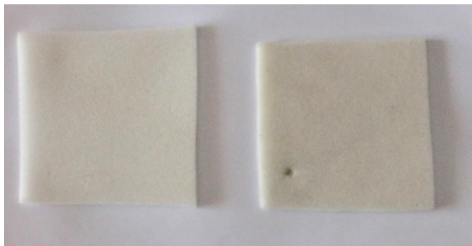
Fig.132 Campioni di PUR forniti dall'artista trattati rispettivamente con Plastivel (a sinistra) e con Vinavil (a destra). Si può notare la differenza di risultato, sia dal punto di vista cromatico che dalle proprietà meccaniche del materiale.
