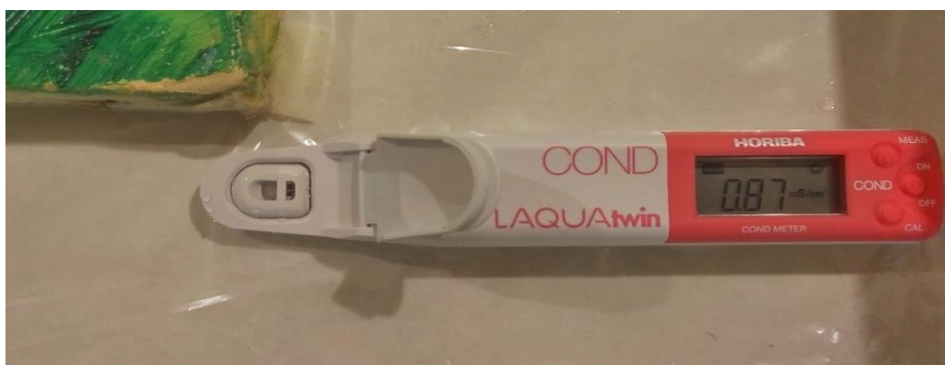
Fig.82 Misura della conducibilità della superficie.
