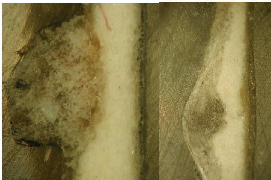
Fig.72a (sx). Osservazione del campione consolidato con Plexisol e Dowanol PM al 10% solo dal recto; b. (dx) Campione consolidato con Plexisol e Ligroina dal recto.
